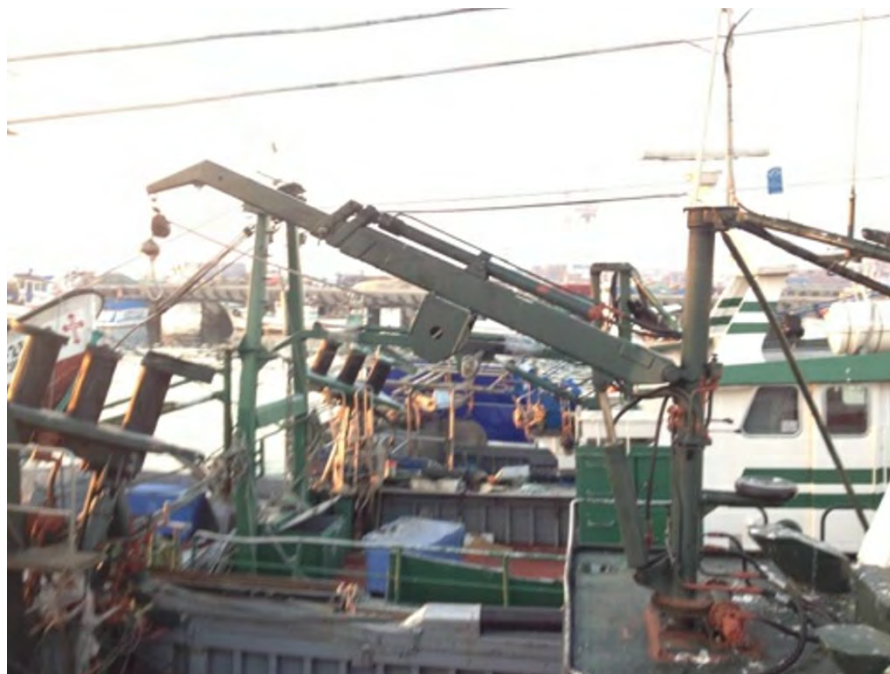
Figura 12: Grua de enchimento e descarga
